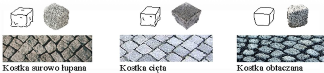
Fig. 2 Pflastersteinarten in Bezug auf die Bearbeitungsmethode
